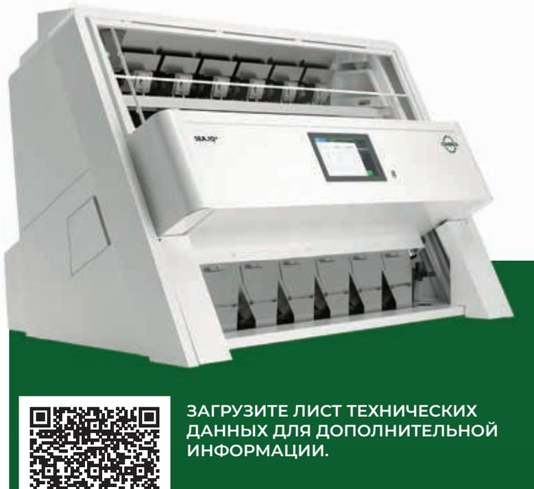
SEA.IQ PLUS можно настраивать строго под ваши потребности. Конфигурация с несколькими питающими лотками дает максимальную гибкость, а плавный поток сокращает число повреждений. Практичная возвратная функция лотка позволяет работать с разными продуктами в одной системе.
